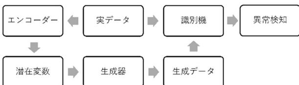
図3 Efficient GANの処理フロー
